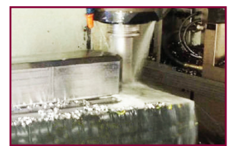
Usinage d'Inconel avec la nouvelle plaquette SPINWORX® DR12-8B3
