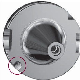
Cono equilibrado con un agujero en oposición para compensar el desequilibrio original del cono
