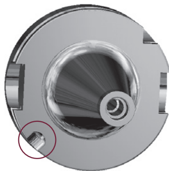
Gewuchtete Aufnahme mit Ausgleichsbohrung
